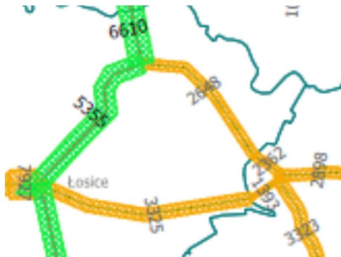
Rysunek 6 Średni dobowy ruch pojazdów silnikowych na drodze wojewódzkiej w Gminie Stara Kornica
