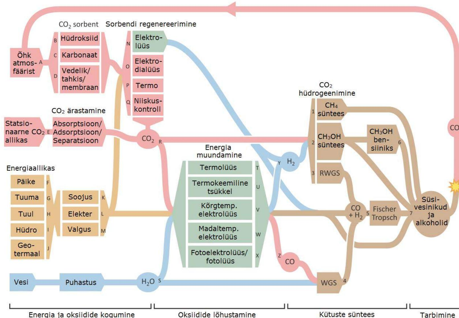
Fischer-Tropsch süntees hõlmab kõikvõimalikke katalütilisi kütuste sünteesimise protsesse. WGS – (water-gas shift) vesi-gaasi reaktsioon, RWGS – (reverse water-gas shift) pöördvesi-gaasi reaktsioon.
